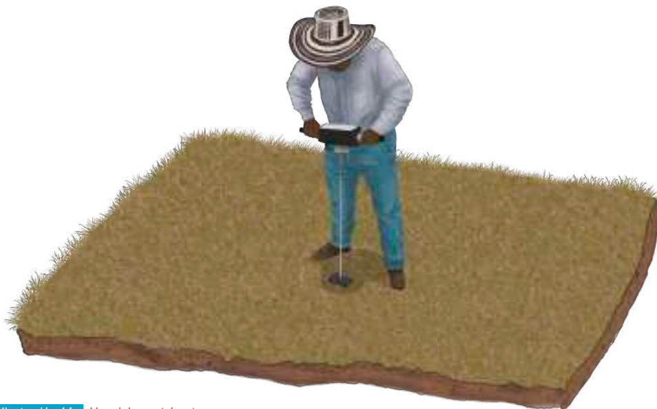
Ilustración 14. Uso del penetrómetro
