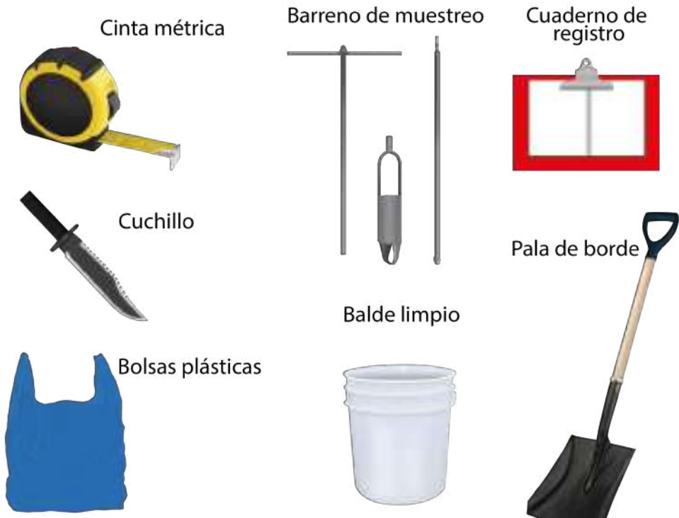
Ilustración 16. Material necesario para el muestreo de suelos
