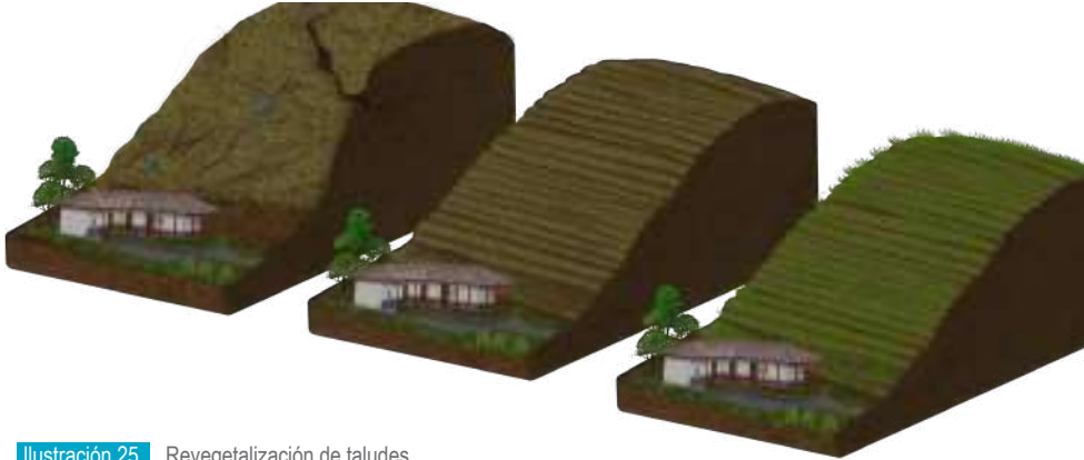
Ilustración 25. Revegetalización de taludes
