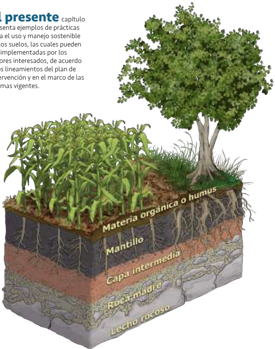
Ilustración 11. Perfil de suelo y sus diferentes usos
