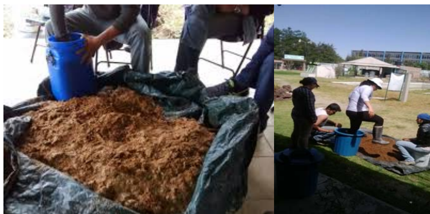
Foto 31 y 32. Mezcla de materiales durante la elaboración de la fase sólida y Apisonamiento de los materiales en el contenedor.
