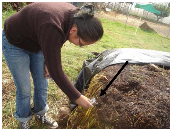
Foto 28. Toma de temperaturas en la composta, lo cual se puede realizar con un termómetro bimetálico con vástago.
