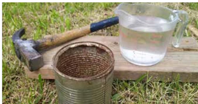
Figura 2. Elementos para hacer la prueba de infiltración. Foto: Marc Gràcia.
