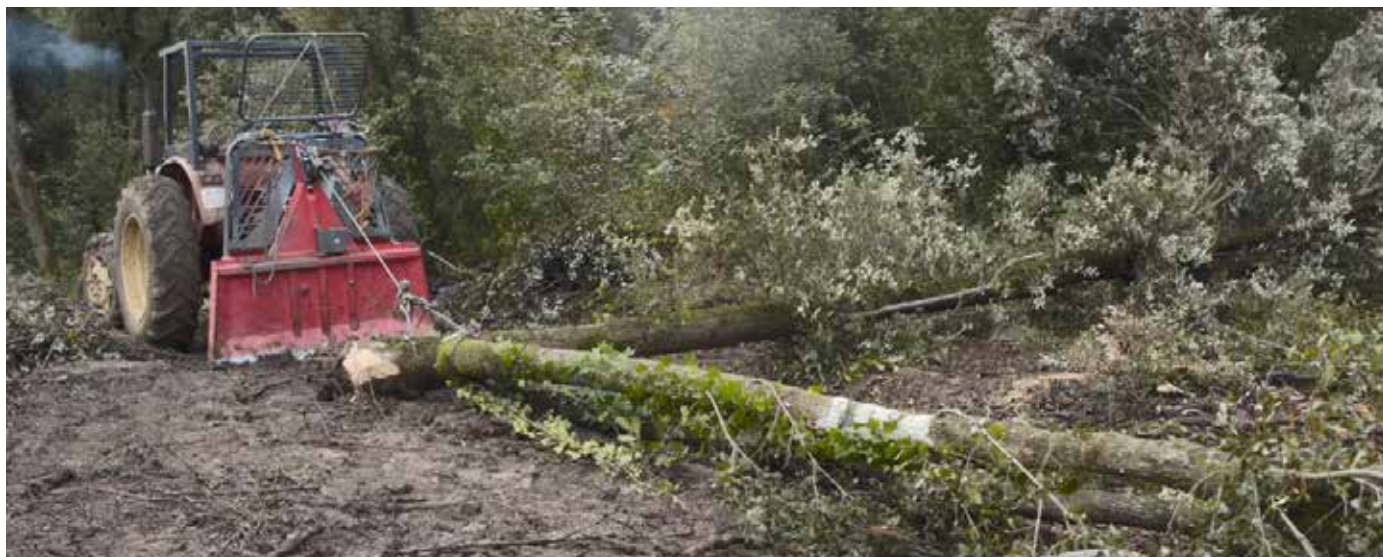
Figura 1. El arrastre de los troncos fuera del bosque determina en gran parte el coste total del aprovechamiento forestal. Foto: AVVideos.
