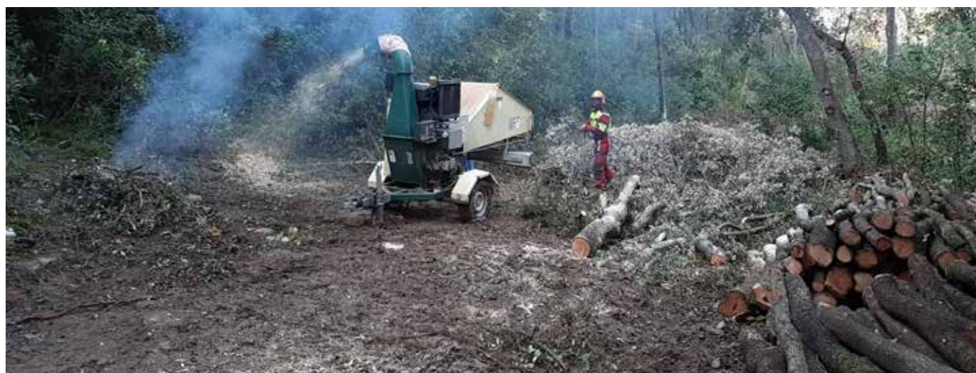
Figura 1. Astillado de las ramas en el campo con una trituradora para producir BRF. Foto: Montse González, AVVideo.
