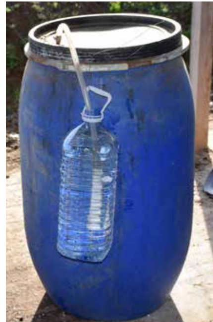
Figura 2. Recipiente para preparar biofertilizantes cerrado herméticamente con una manguera acoplada a la botella llena de agua para evacuar los gases. Foto: Ángela Justamante.
