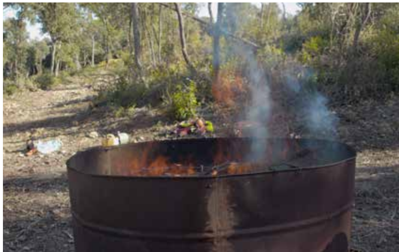
Figura 1. Caldera transportable para producir biochar directamente en el bosque. Foto: AVVideo.
