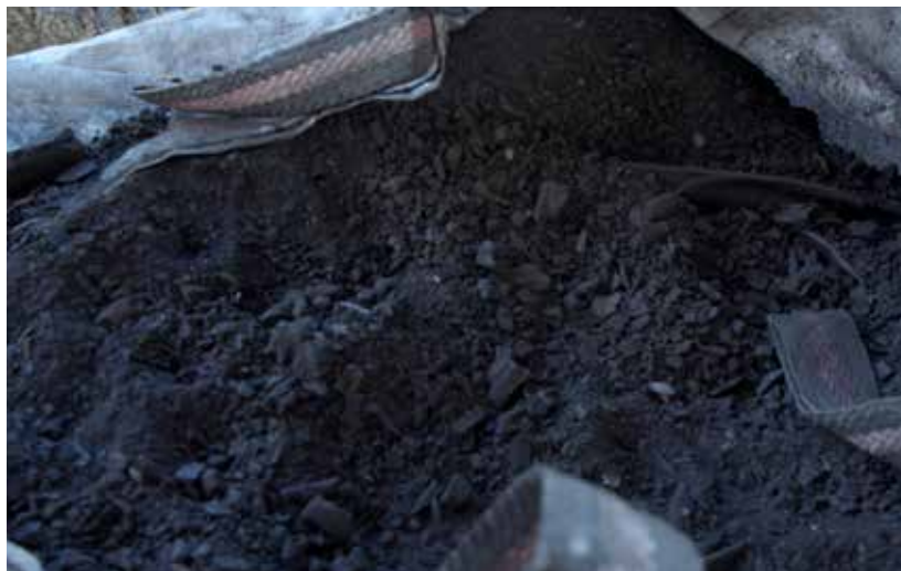
Figura 2. Muestra de biochar obtenido por pirólisis de biomasa vegetal. Foto: AVVideo.
