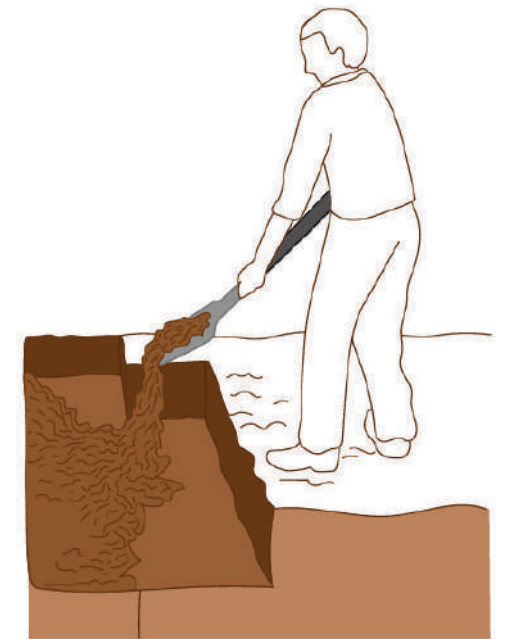
6 Escarba otra zanja con las mismas medidas. Usa la tierra que sacas de aquí para tapar la primera zanja.
